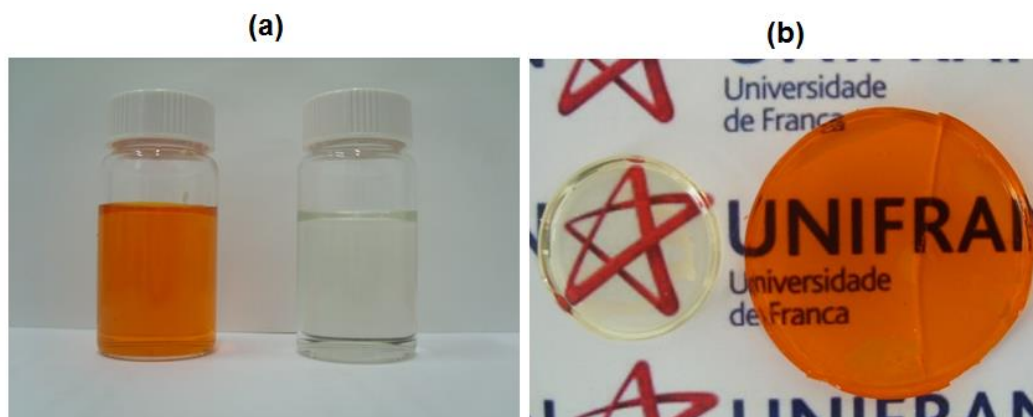
Figura 5: Teste de afinidade entre o corante OII e PEO1900 (a) Fotografia da solução de OII antes e após o contato de 24h (b) Fotografia da membrana de PEO1900 antes e após o processo adsorptivo
